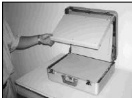
Paso 2 Suba la luminaria.
