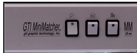
Panel de control para la selección de la luz o las luces que se desea utilizar
