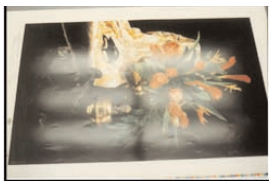
Geometría inadecuada: brillo excesivo
