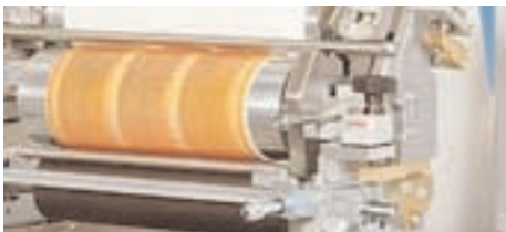
El cabezal de impresión flexográfica del VCM-300 incorpora un lector digital para el ajuste exacto de impresiones
